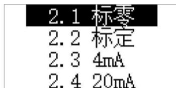
选择“2.1 标零”菜单项进入标零页面，在倒计时 15 秒完成后设备显示标零结果。
