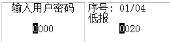
输入数据时通过“上”/“下”键来增加/减少当前选中位的值；通过短按“确认”键移动选中位；通过长按“确认”键确认当前值；通过短按“设置”键返回到上一级。
